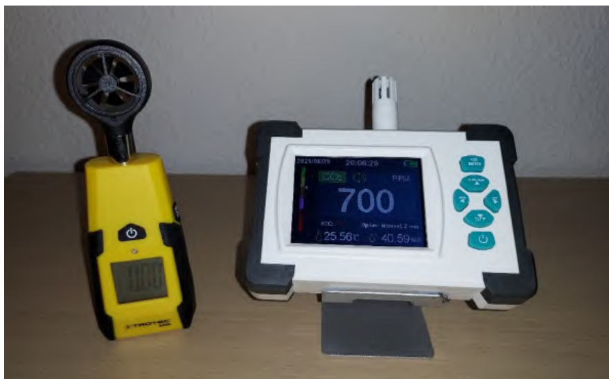
Figura 3 Modelo de medidor de \text{CO}_2 y anemómetro (Fuente: Luis Jiménez López)
