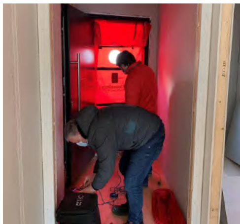
Figura 14. Ensayo Blower Door (Fuente: Medgón PassivHaus)
